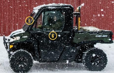
① **GANZER WINDABWEISER – MIT GEHÄRTETER BESCHICHTUNG**
