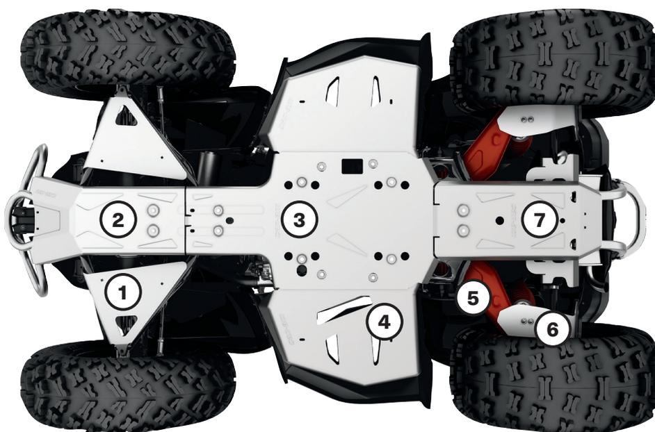
Für ultimative Beständigkeit und Robustheit ist unser gesamter Aluminium-Unterbodenschutz aus Aluminium 5052 H32 mit einer Dicke von 4,5 mm gefertigt.
