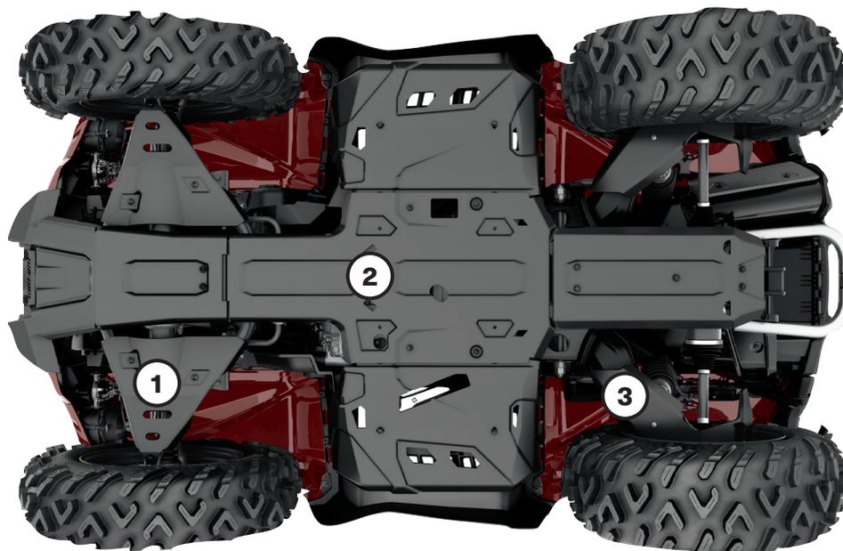
Unser Kunststoff-Unterbodenschutz gleitet ruckfrei und leise über Hindernisse und bietet dabei großartigen Schutz in rauem Gelände. Gefertigt aus 6 mm dickem, abriebbeständigem, thermogeformtem hochmolekularem Polyethylen (PE-HMW).
