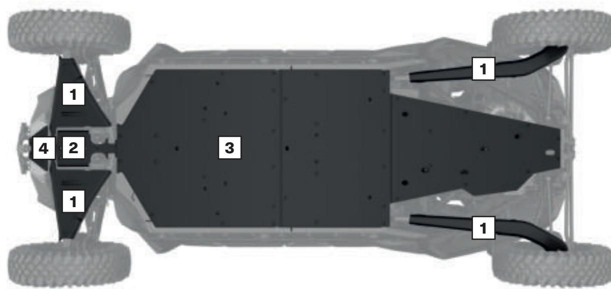
Unser Kunststoff-Unterbodenschutz gleitet ruckfrei und leise über Hindernisse und bietet dabei großartigen Schutz in rauem Gelände. Aus verschleißbeständigem, thermogeformtem hochmolekularem Polyethylen (PE-HMW) mit einer Dicke von 10 mm.
